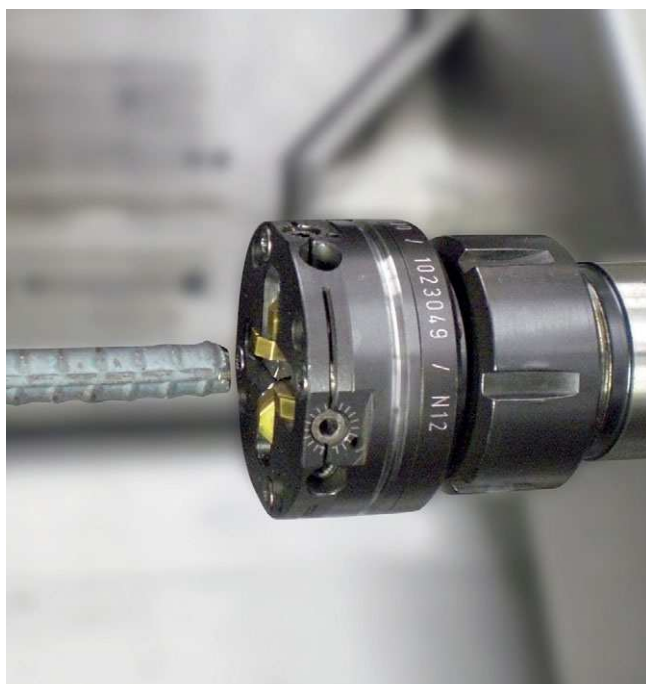
Schälen von Rippenstahl mit FS-Schälkopf Barpeeling of rebar with FS Turning head
